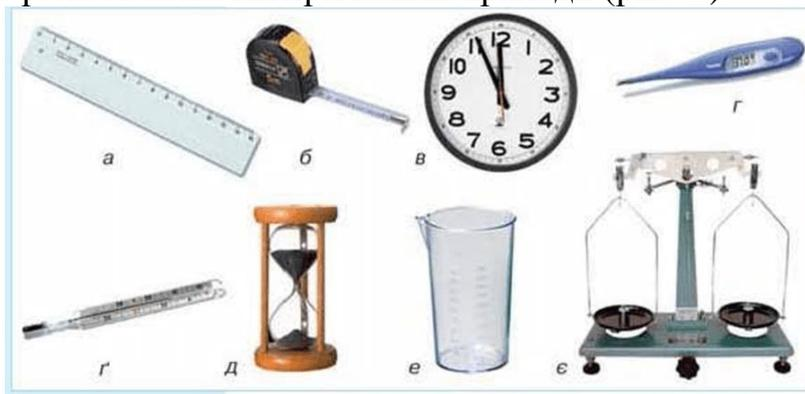
Щоб точно визначити розміри тіла або відстань між тілами > використовують різноманітні лінійки» метри» рулетки. Лінійкою можна виміряти тіла невеликих розмірів чи невеликі відстані між ними» тоді як рулеткою зручно вимірювати відстані в кілька метрів. Для вимірювання важливо знати ціну поділки приладу. Ціна поділки — це значення найменшої поділки шкали. Ціна поділки лінійок» якими ви користуєтесь» — 1 мм.
